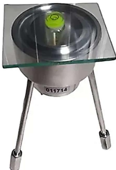
Viscosímetro copo FORD para determinação de viscosidade, completo com software, cronômetro e acessórios
