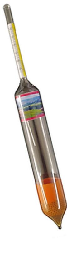
Um instrumento especializado projetado especificamente para medir o teor de água no leite. Com faixa de escala de 15/40 e termômetro embutido, este densímetro é ideal para determinar com precisão o teor de água em misturas lácteas. Aferido a 20°C, este instrumento foi calibrado na temperatura ideal para medições precisas e confiáveis.
