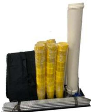
KIT Ensaio de aspersão da Polimedição foi desenvolvido para realizar ensaios de uniformidade de distribuição de água em sistemas de Irrigação por aspersão.
