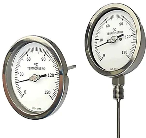
Este termômetro bimetálico é construído inteiramente em aço inoxidável com diâmetro de 100 mm, garantindo durabilidade e resistência a ambientes agressivos. O termômetro possui faixa de temperatura de 0 a +100°C e saída traseira com rosca BSP de 1/2", junto com sonda de 1/4 x 100mm. Além disso, também está disponível em outros diâmetros de
