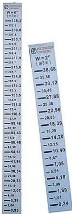
Um produto de qualidade projetado e fabricado pela Polimedição, fabricante líder em instrumentação. Esta régua é construída com material durável, garantindo sua longevidade e confiabilidade quando utilizada com calha PARSHAL. O material também o torna resistente à corrosão e degradação, tornando-o adequado para uso em diversas condições ambientais.
